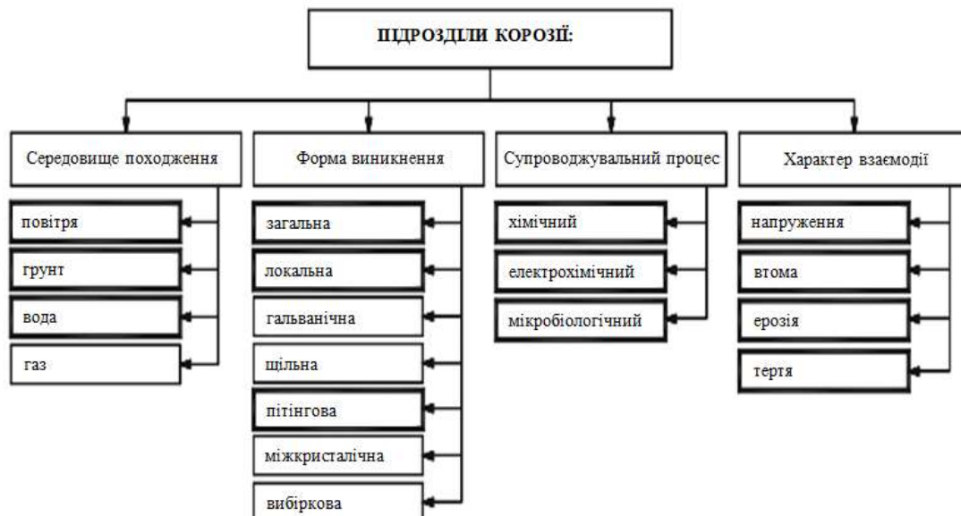
Рисунок 2 – Класифікація найбільш часто поширених видів корозії. Figure 2 – Classification of the most common types of corrosion.
